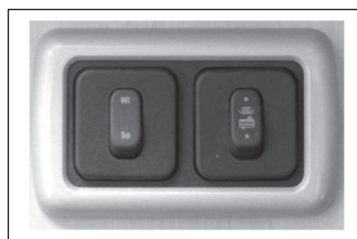
Bild 53 Umschalter Sommer/Wintertank(links) Schalter Tankheizung(rechts), (Abb. ähnlich)
